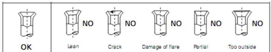
**13) IG + AG: Gebördelte Leitungen** zentrisch auf die Anschlüsse aufsetzen u. die Überwurfmutter mit dem vorgeschriebenen Drehmoment **festschrauben**.
